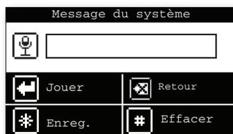
**Enregistrement d'un message** — Appuyer sur la touche marquée d'une étoile (\*) pour débuter l'enregistrement puis dicter le message d'identification (8 secondes maximum). À la fin de l'enregistrement, l'Agri-Alert communique la nouvelle identification vocale sur le haut-parleur.
