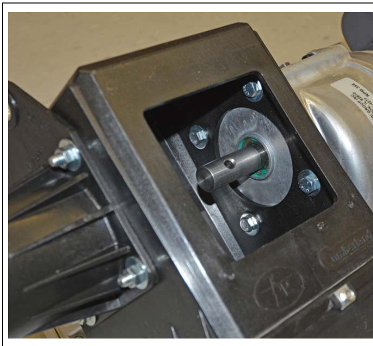
Рисунок 5Y Установка блока управления на привод
