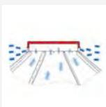
Respiro de teto para saída do ar quente, com funcionamento realizado pelo diferencial de diâmetro entre o colar do funil e a tampa de abertura superior. Este respiro na tampa fica centrado no topo do silo e possui melhor desempenho que o respiro lateral
